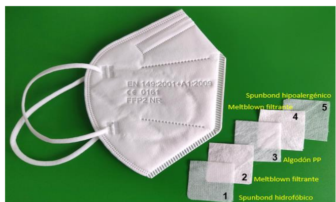
Imagen 2. Esquema de composición de una mascarilla FFP2. (Fuente: Ficha técnica mascarilla FFP2 Stranfford Textil, SL) (16)
